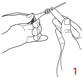
Posizionare uno o più stop in silicone sull'estremità del puntale corrispondente usando la pinzetta.
