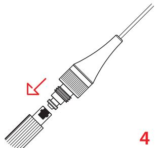
Inserire il fermo del sistema a baionetta del pistone e rilasciare lo stantuffo della siringa.
