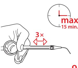
Quando il materiale è stato posizionato completamente, premere lo stantuffo della siringa 3x entro 15 min. dal trattamento per espellere il materiale in eccesso.
