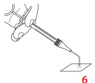
Preparare il materiale da otturazione su un blocco per impasto e trasferire la quantità di materiale necessaria nel serbatoio. Inserire la punta (del puntale) nel materiale da otturazione più volte finché non si riempie.
